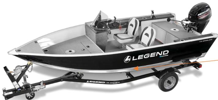
Coque Profonde en V (comparé au bateau de Bass), par conséquent, il se situe au-dessus de la surface de l'eau
