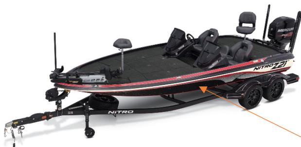
Coque en V peu profonde, très basse par rapport à la surface de l'eau à flot et souvent avec un gros moteur hors-bord
